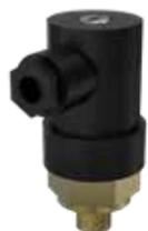
Dispositivo que se aplica al circuito neumático de las bombas de membrana. Permite contar el número de carreras realizadas por las membranas y, por tanto, su número de ciclos. Así pues, este dispositivo permite activar distintos tipos de controles, como, por ejemplo, los litros de líquido suministrados por la bomba en función de su cilindrada y también permite controlar el funcionamiento de la bomba a distancia.
