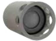
Válvulas de retención especialmente indicadas para el montaje vertical en la parte final de los tubos de aspiración tanto de bombas centrífugas como neumáticas. Estas válvulas antirretorno evitan el vaciado de la tubería de aspiración permitiendo que las bombas permanezcan siempre cebadas. Medidas disponibles: 1", 1" 1/4, 1" 1/2, 2", 3". Materiales de construcción: PP y PVDF.
