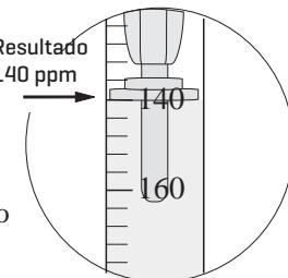
Si la punta del émbolo alcanza la línea inferior de la escala (200 ppm) antes de que se produzca el cambio de color en el resultado final, rellene el valorador y continúe con la valoración. Cuando registre el resultado de la prueba, asegúrese de incluir el valor de la cantidad original de reactivo dispensado (200 ppm).
