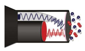
Las moléculas de los luminóforos se estimulan con la luz azul y luego emiten una luz roja, que es detectada por un fotodiodo. La electrónica óptica informa la concentración de OD en mg/L.
